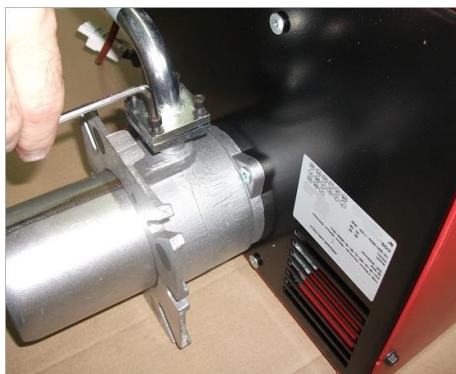
4) Прикрепить ГАЗОВАЯ ramпа в фланец при помощи 4-х винтов с цилиндрической головкой;
